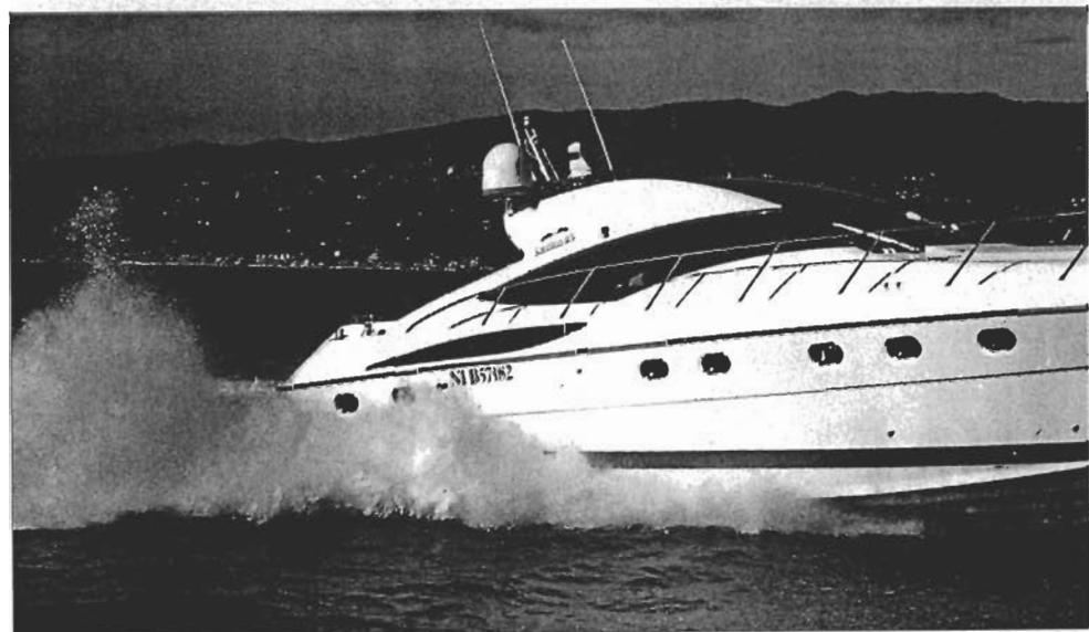
Il Sarnico 65' durante un passaggio sull'onda: lo scafo apre bene l'acqua e lo spigolo deflette efficacemente gli spruzzi verso l'esterno in modo da assicurare navigazioni asciutte e confortevoli.
