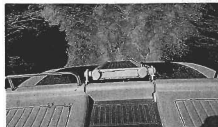
La pasarela hidráulica se repliega en navegación.
