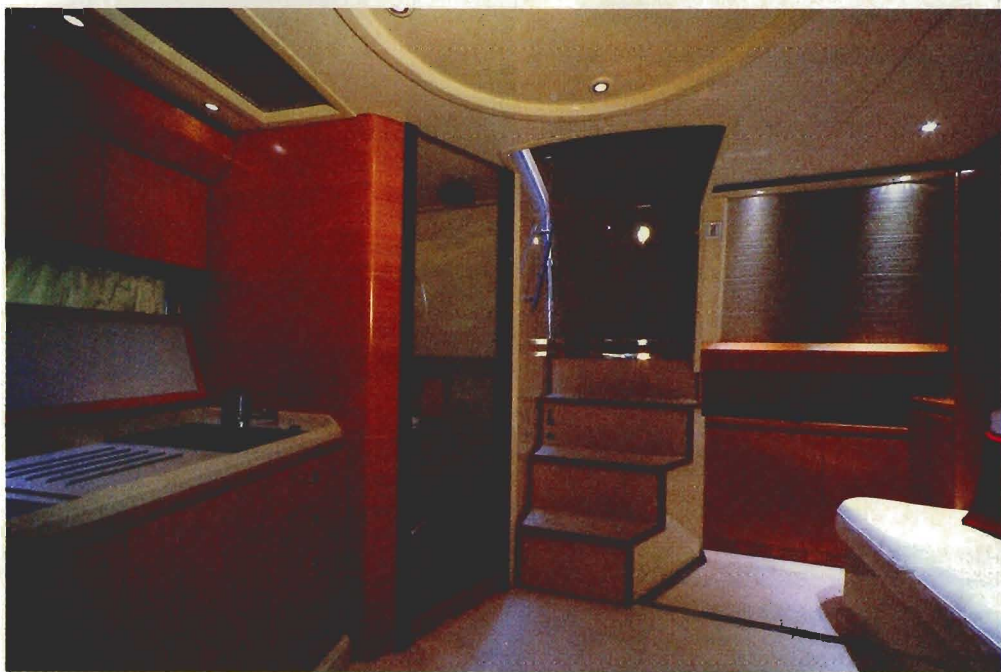
El cuarto de aseo está colocado bajo el puesto de gobierno, donde la altura es máxima. A babor se distingue el mueble que contiene el frigorífico, que quedará oculto detrás de la escalera móvil para acceder a la cabina de popa.
