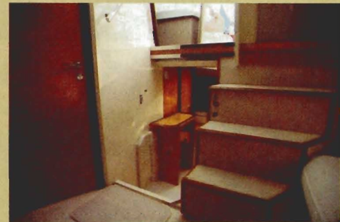
La escalera se puede mover sobre unas guías metálicas y así se tiene acceso a la segunda cabina o a un considerable espacio de estiba. En la imagen se aprecia la mesa del salón estibada contra el mamparo.
