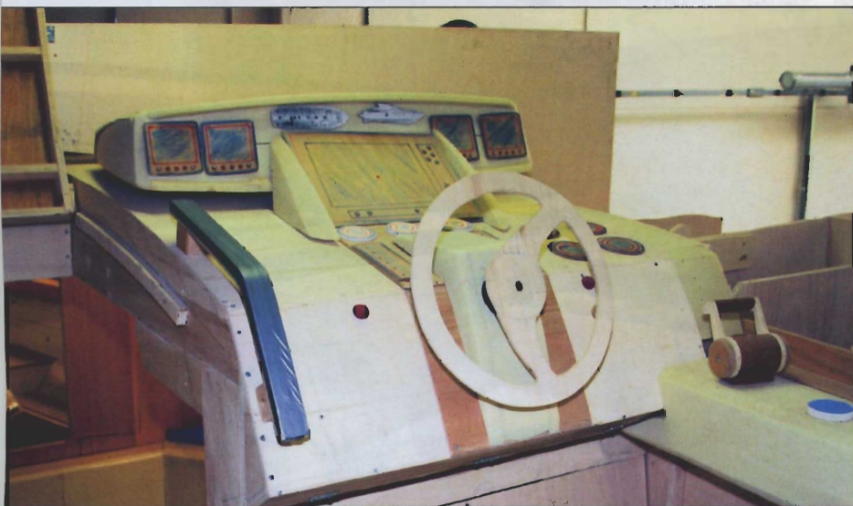
Interiér je u každého nového modelu vždy předem postaven z překližky celý „nanečisto“.
