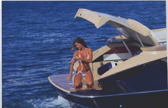
Elektro-hydraulický mechanismus zvedá celou záď, čímž se otevírá garáž, kam se vejde například pomocný nafukovací člun. Na zádi nechybí ani sprcha.
