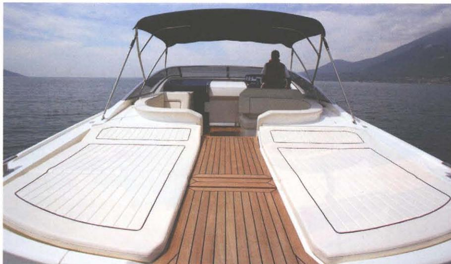
**Ombra e sole.** Tra le cose che abbiamo apprezzato di più è il sistema escogitato per tendalino a scomparsa. Si aziona elettricamente e va a sparire sotto al prendisole. Una volta alzato bisogna montare manualmente i quattro tiranti, operazione che chiede un paio di minuti utilizzando gli agganci rapidi (foto sotto a sinistra). Alla fine l'insieme è molto robusto grazie ai tenditori (foto sotto) e il tendalino è uno di quelli utilizzabili senza timori anche a tutta velocità.
